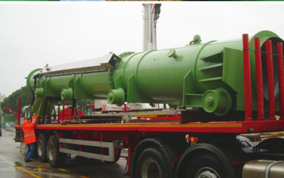
Impianto di sollevamento acque di irrigazione, particolare pompe carrellate – Cantonazzo (RO)
